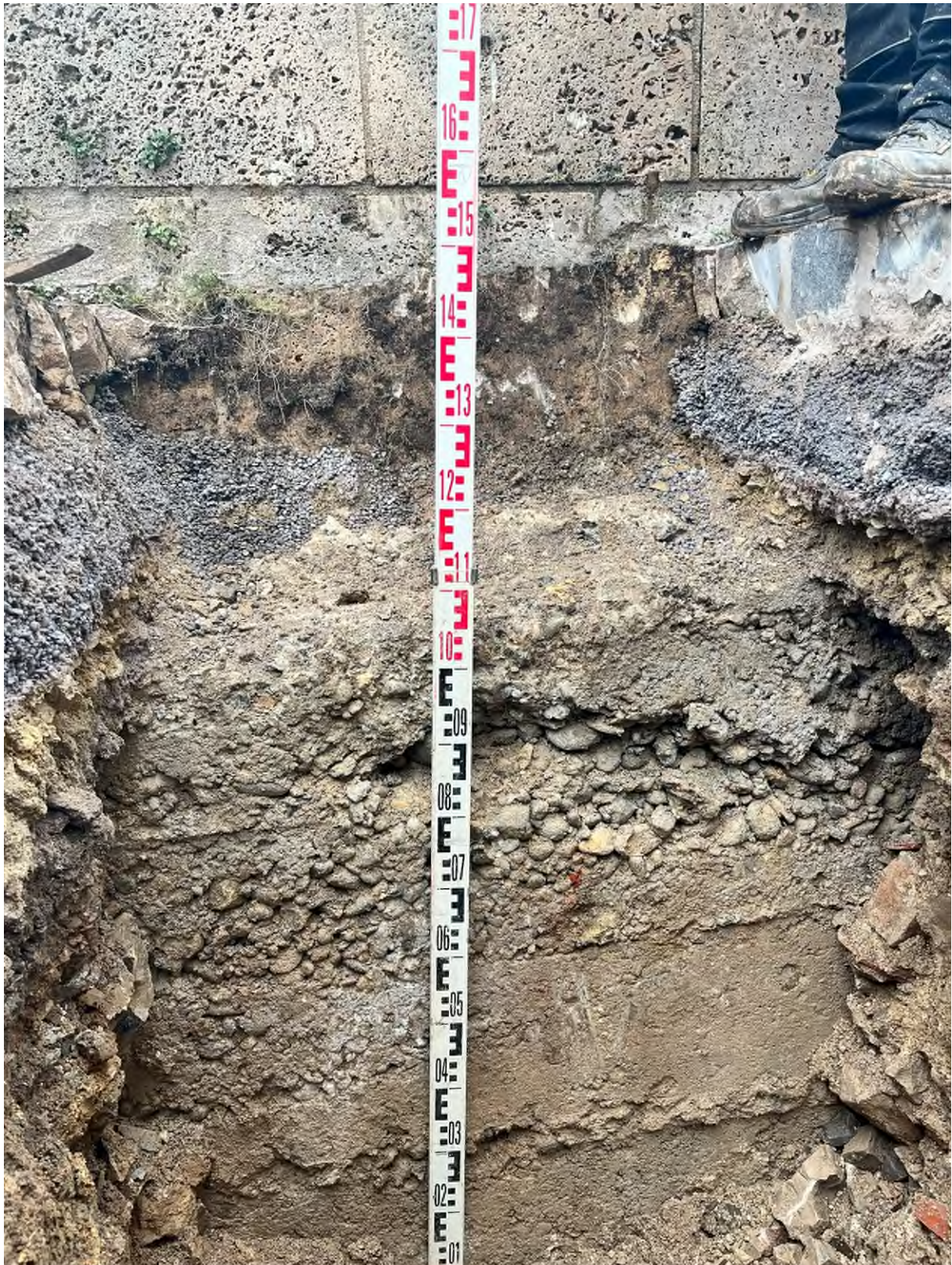
Abbildung 6 Betonfundament hinter Stadtmauer
